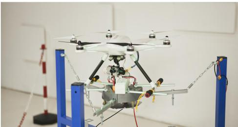
Le forze misurate possono essere usate per rilevare malfunzionamenti di parti come ESC, motori ed eliche.
