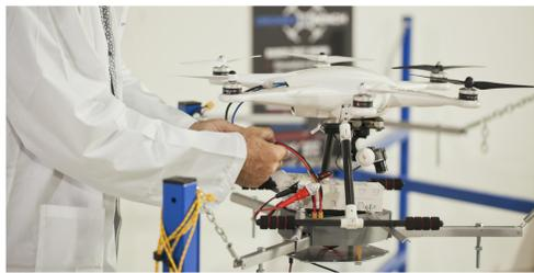
DronesBench è in grado di misurare contemporaneamente e senza disassemblare il drone: (i) la spinta fornita dal drone (ii) il consumo istantaneo di energia del drone, e (iii) gli angoli di beccheggio, imbardata e rollio durante il test.
